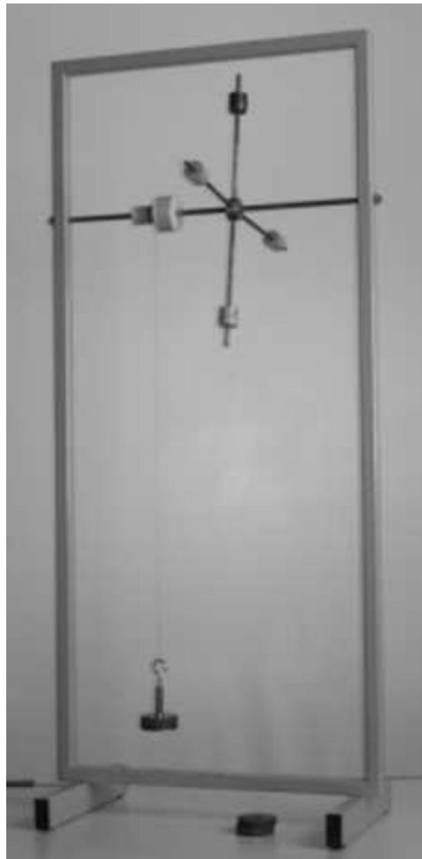
Slika 4.2: Eksperimentalni uređaj za određivanje momenta tromosti.
